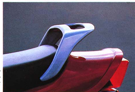
◀V-Maxのイメージを主張するキャブへのエアインテークだがFZXではダミーとなっている。
